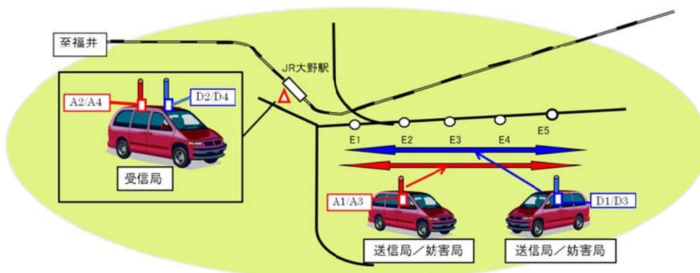
150MHz帯 アナログ・デジタル・400MHz帯 デジタル到達距離測定
