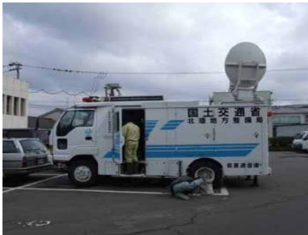
衛星通信車(国土交通省北陸地方整備局)
