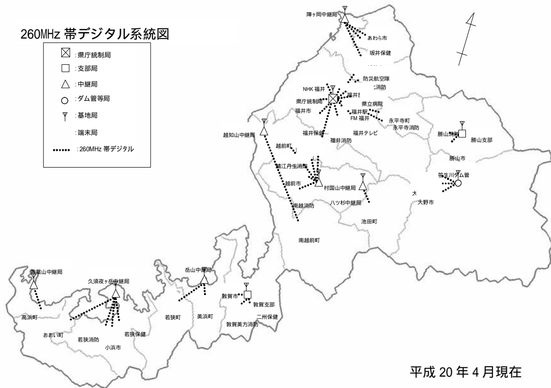
図 1-13 福井県デジタル防災行政無線系統図
