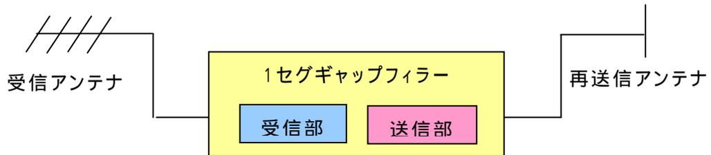
図 2 - 4 ギャップフィルターの系統図
