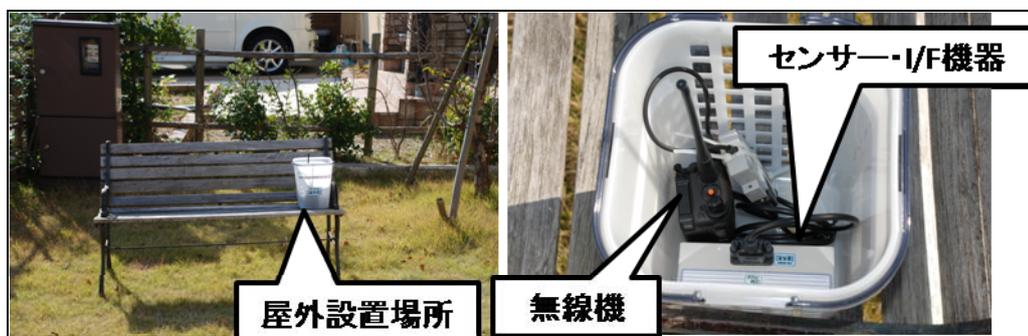
図 2-22 気象センサー屋外設置状況
