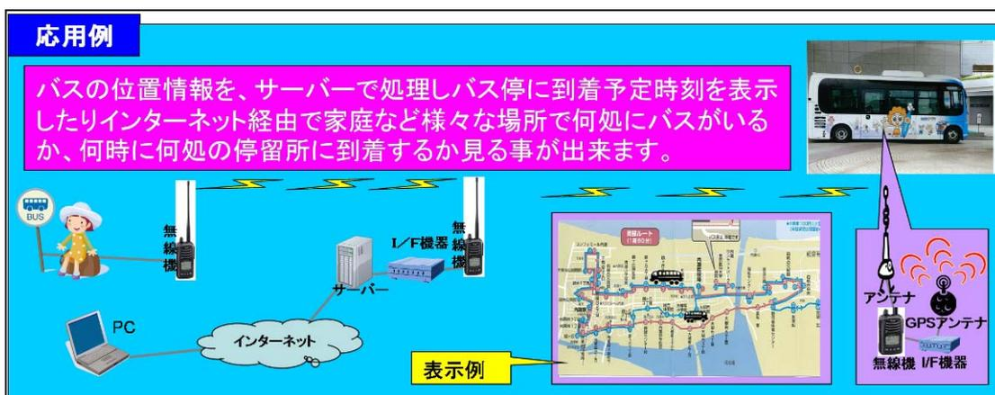
図 2-28 GPS を利用した位置情報の応用例
