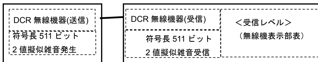
図 2-42 無線機の BER 測定構成
