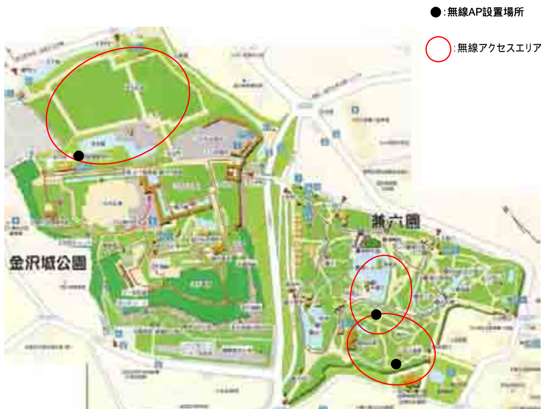
図 3-20 無線 LAN 装置の設置場所と通信エリア
