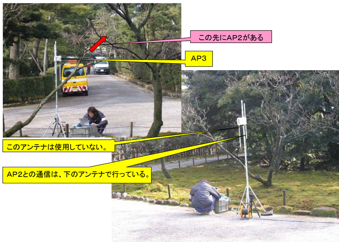
図 4-6 AP3 の仮設状況
