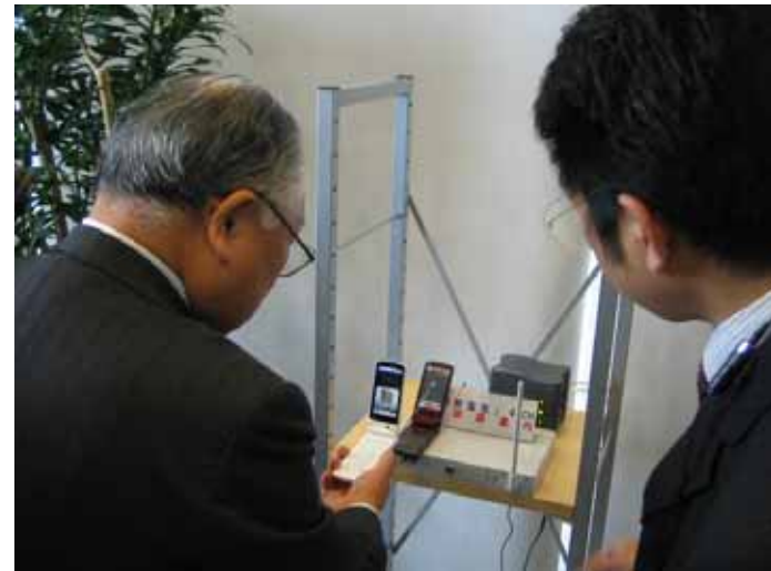
ワンセグ映像配信技術を活用したシステム（屋内通信試験システム）
