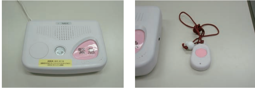
[横須賀市 緊急通報装置とペンダント型ボタン]
