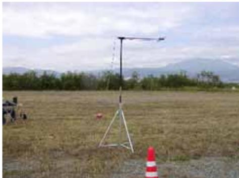
400MHz 帯 標準グ° 体° -ルアンテナ設置状況
