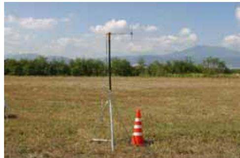
150MHz 帯 標準ダ体°-ルアンテ設置状況
