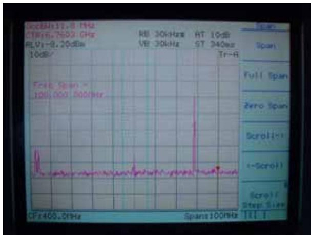
写真4-4 400MHz帯 干渉波測定(その2)
