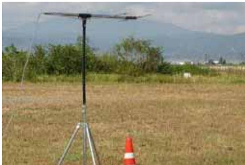
400MHz 帯 標準ダ体°-ルアンテ設置状況
