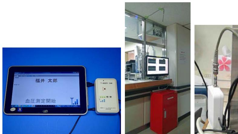
図 3.3-5 子機、模擬セントラルモニターとアンテナ、親機（親機はモニター背後に設置）
