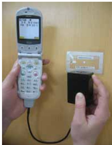
図 3.3 選択した機器を用いて、トイレのドアに貼り付けた電子タグをリーダーで読み取り
