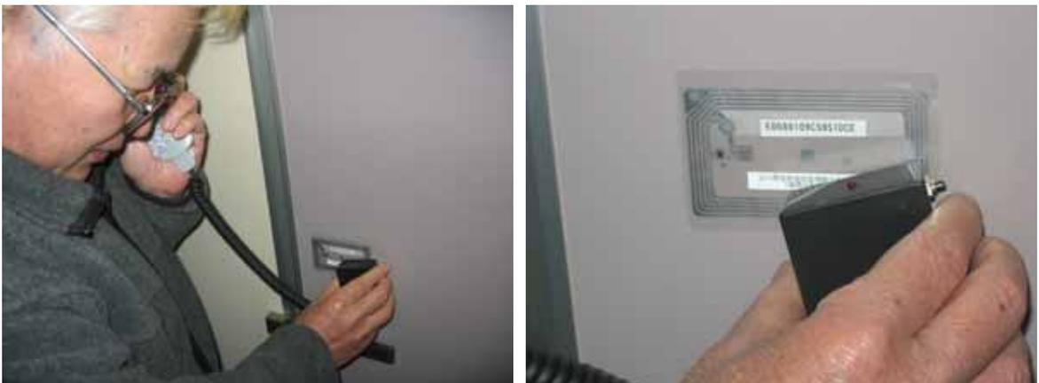
図3.5 電子タグを読み取り、ガイダンス内容を確認（右：手元を拡大したもの）
