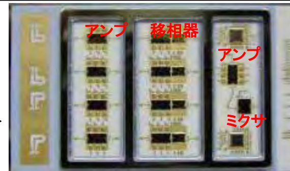
開発した受信モジュール (25.6mm × 54.4mm × 3.9mm)
