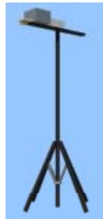
1m高のスタンド上に標準アンテナを設置して計測器で測定
