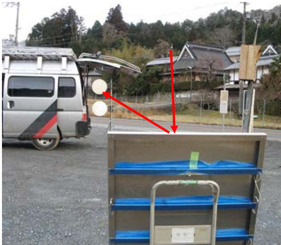
反射板: 1平方メートルのアルミ製(電気興業様協力)
