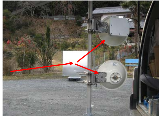
反射板: 1平方メートルのアルミ製(電気興業様協力)
