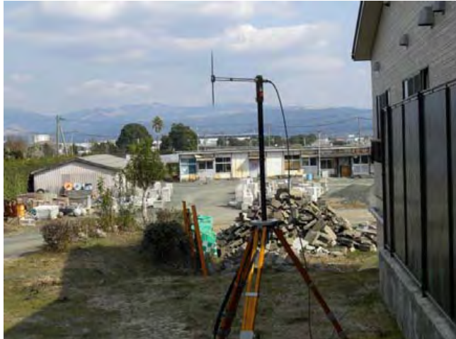
調理室外側での電界強度測定
