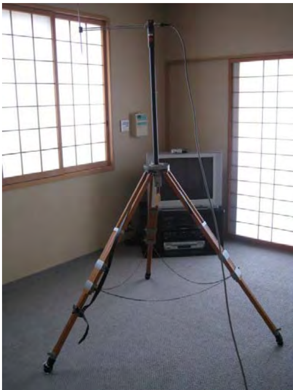
和室 B での電界強度測定
