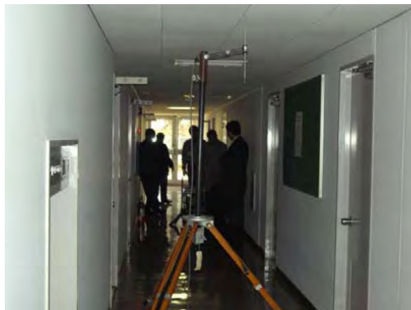
1階廊下中央での電界強度測定
