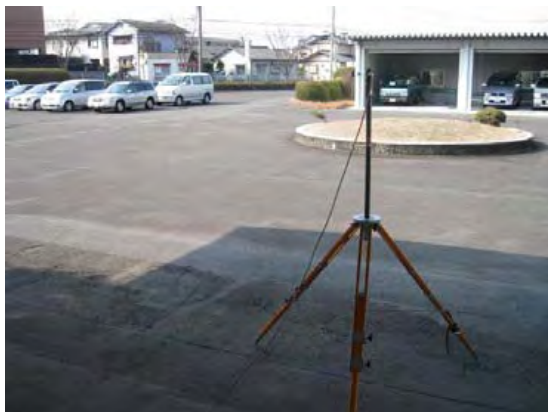
1階エントランス前での電界強度測定
