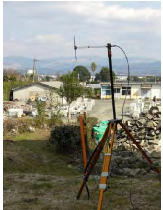
和室 A 外側での電界強度測定
