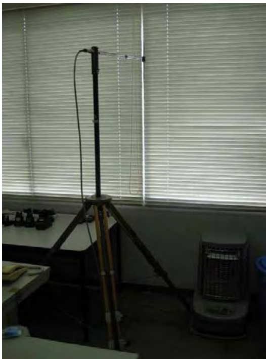
1階校正室での電界強度測定（左：ブラインド有、右：ブラインド無）
