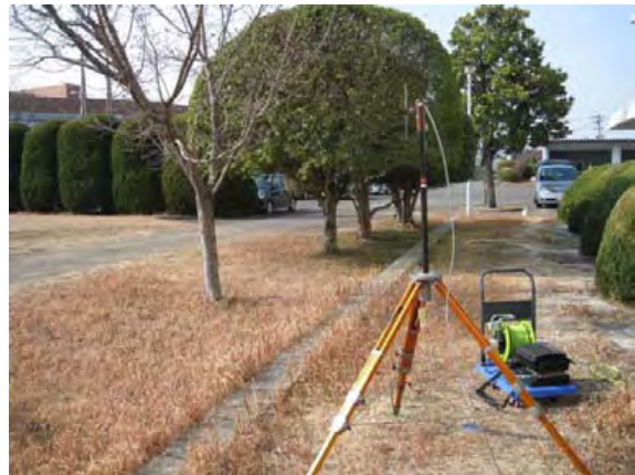
1階中央の外での電界強度測定
