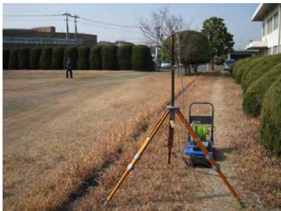
1階校正室の外での電界強度測定
