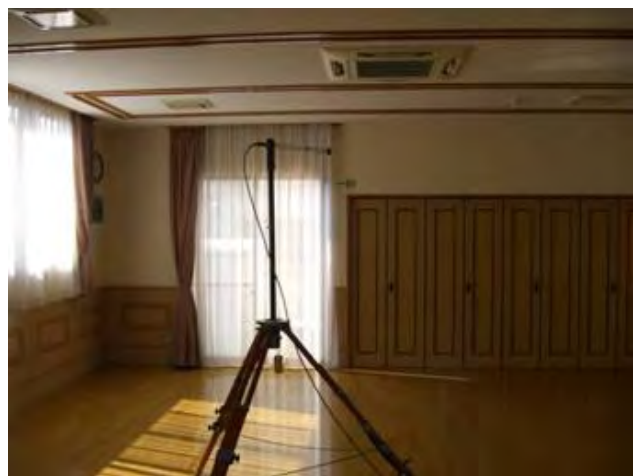
多目的ホール B での電界強度測定
