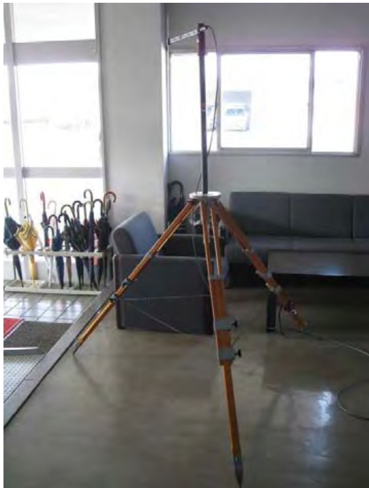
1階エントランスでの電界強度測定
