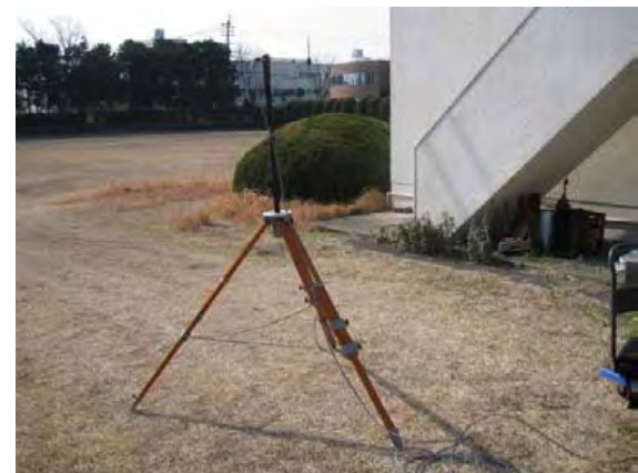
1階校正室の角での電界強度測定
