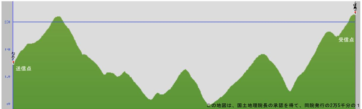
図4-14 送信点 No. 2—受信点間 断面図
