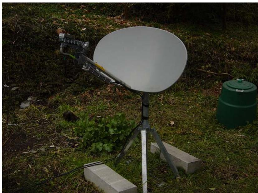
【図4-18】 衛星ネットワークのアンテナ
