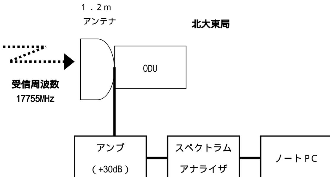
図 2.1.8 受信スペクトラム波形 測定構成
