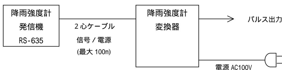
図9.1.14 降雨強度計 配線系統図
