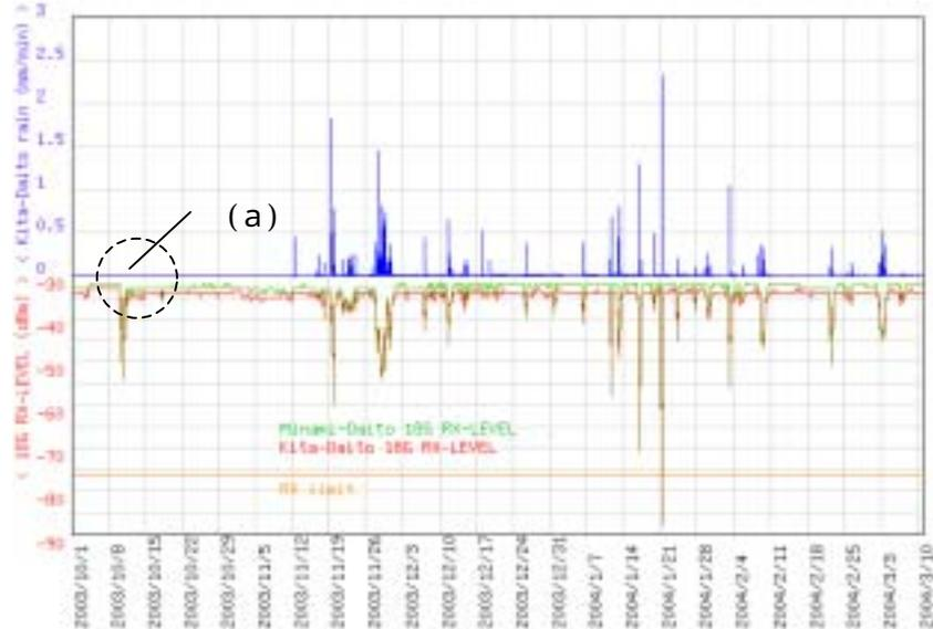
図 2.2.1 時間経過グラフ（北大東局 降雨強度 / 受信レベル）
