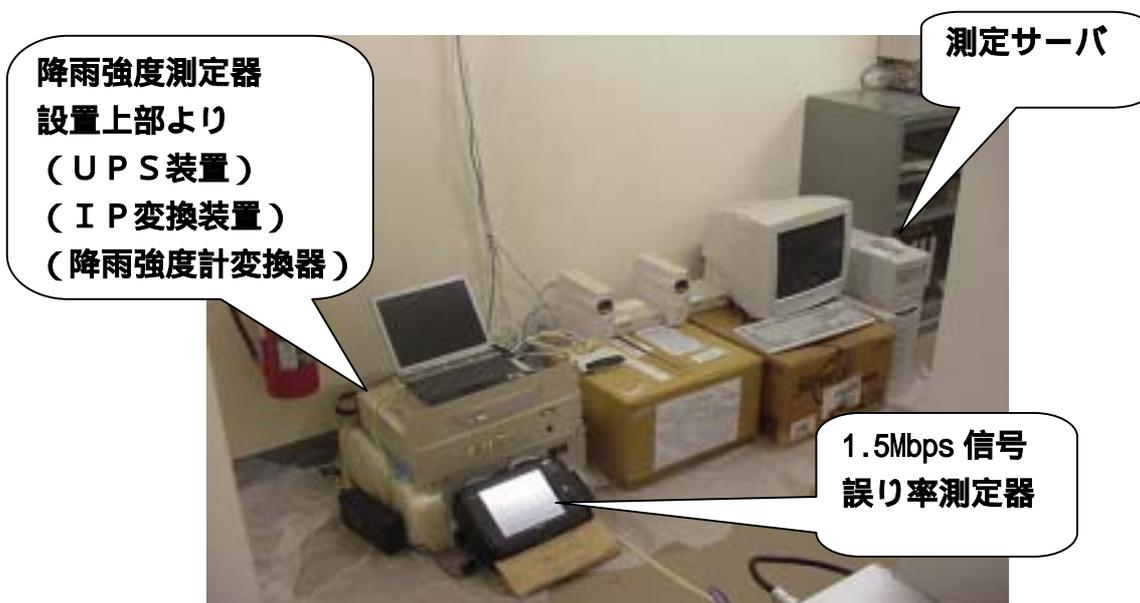
図 2.1.7 測定器材 設置状況
