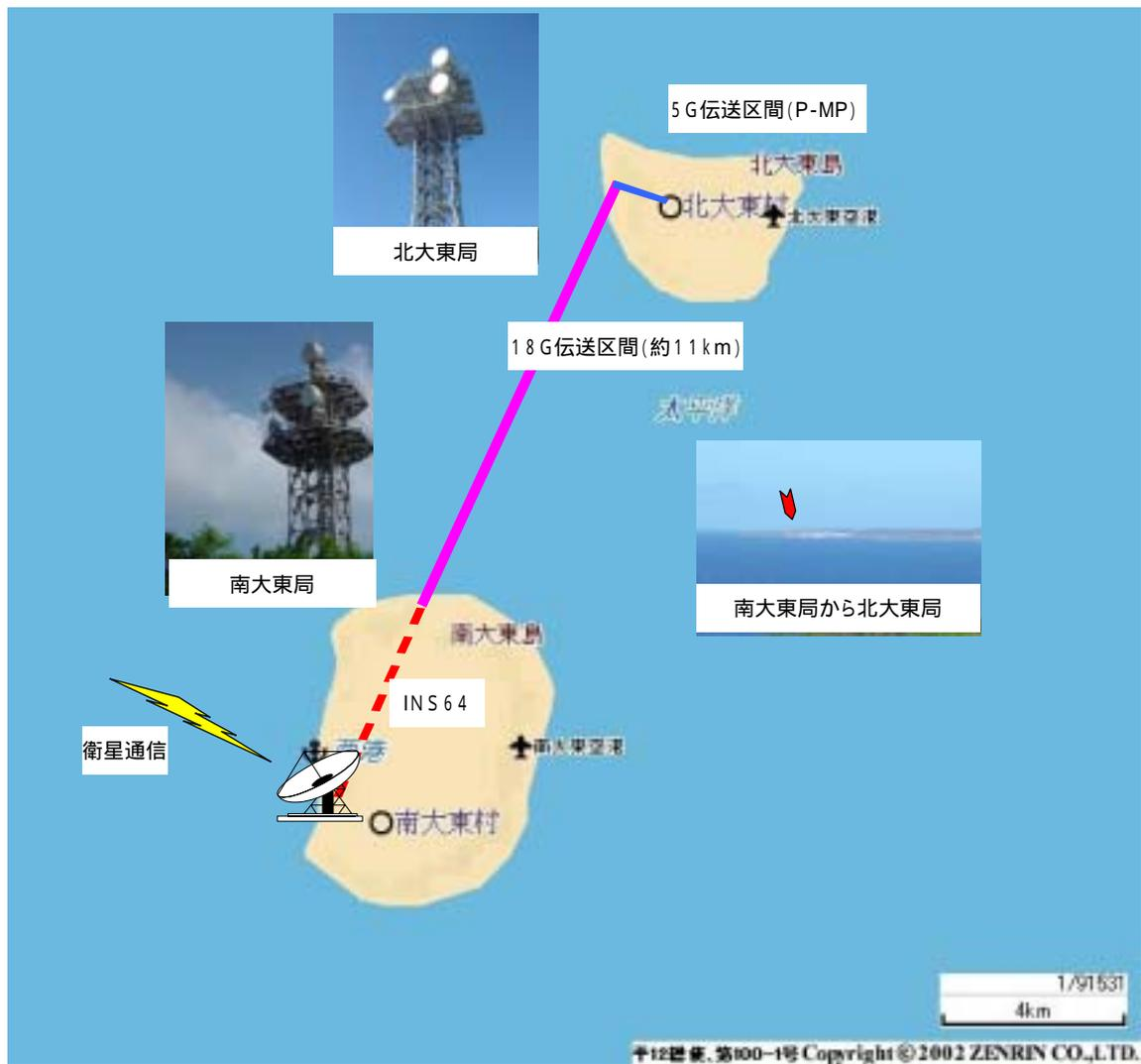
図 2.1.1 試験回線の系統図
