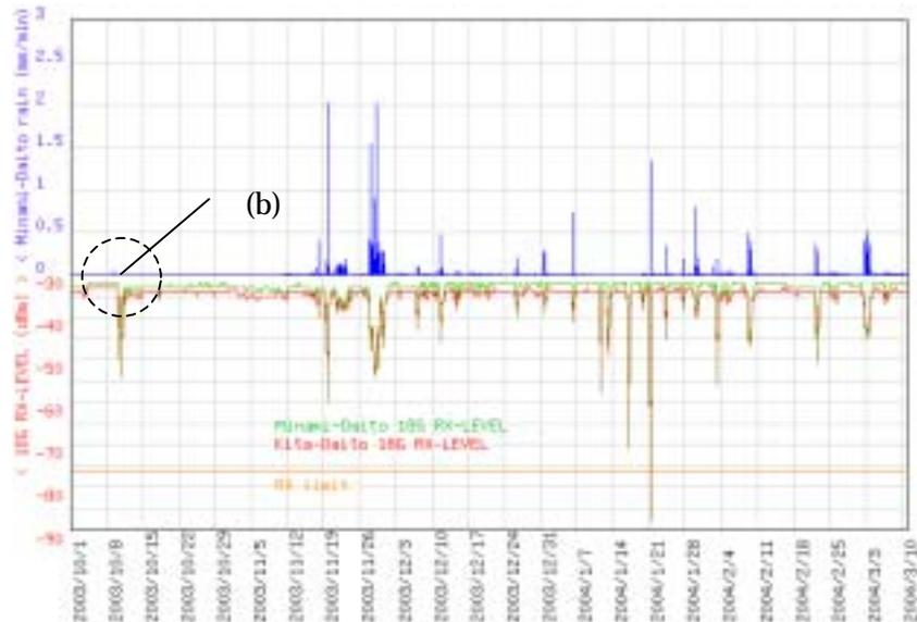
図 2.2.2 時間経過グラフ（南大東局 降雨強度 / 受信レベル）
