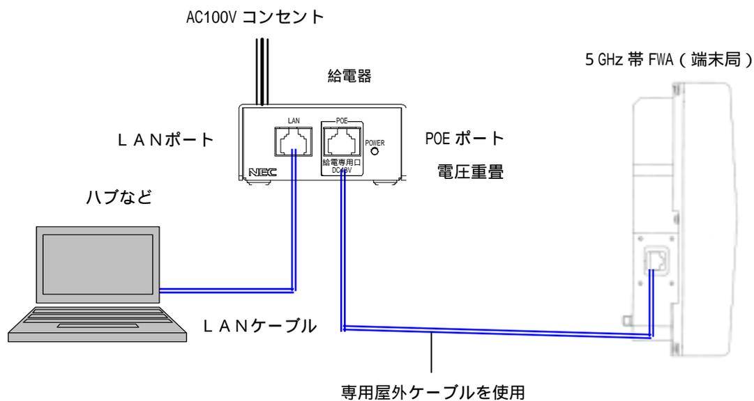
図9.1.8 5GHz帯FWA (端末局) 接続構成図
