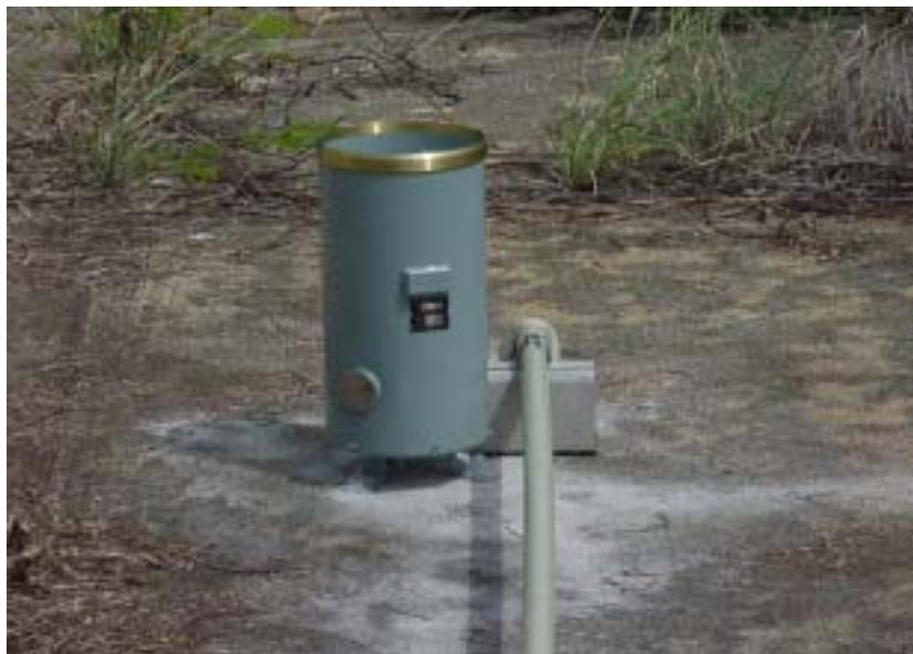
図 9.1.15 降雨強度計（発信機）
