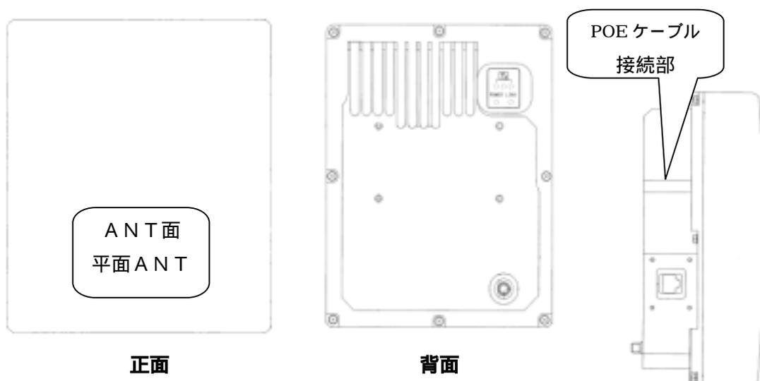
図9.1.7 5GHz帯FWA (端末局) 外観図 左側面
