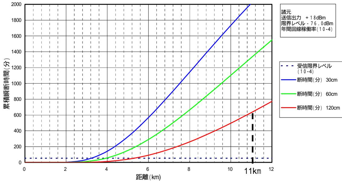
図 2.1.5 伝送距離対年間不稼働率（机上計算）グラフ
