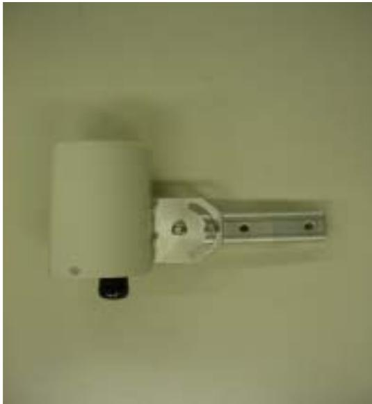
図9.1.11 セクタアンテナ(指向性：60度)
