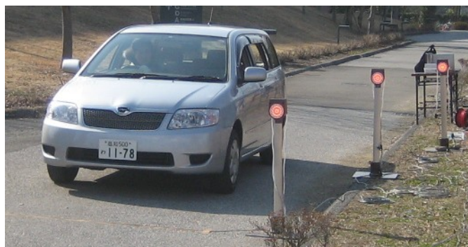
図 16 視線誘導灯（デリネータ）を用いた公開試験
