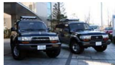
小型移動電源車 (4WDオフロード乗用車タイプ) 北海道、東北、信越、北陸、東海、近畿及び四国へ配備
