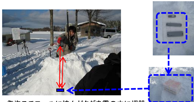
発泡スチロールに挟んだタグを雪の中に埋設
