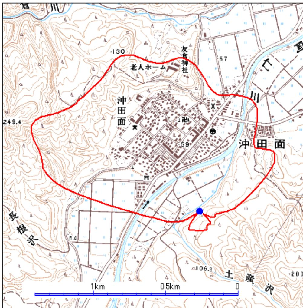
沖田面中継局は、鷹巣局と同じチャンネルですが、偏波面は**垂直偏波**で送信されています。地上デジタルテレビ放送用の電波を受信するためには、下図のようにUHF専用のアンテナを垂直偏波に設定して設置する必要があります。
