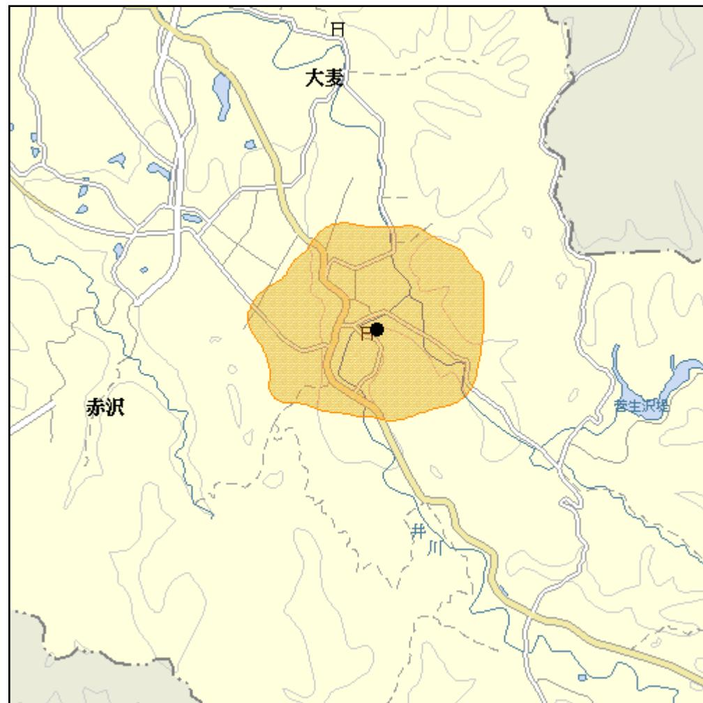
注1 エリアは、電波法令に規定する「放送区域」を表しており地上10メートルの高さで、送信所からの放送波の電界強度が1mV/m以上得られる区域として算出されたものです。
