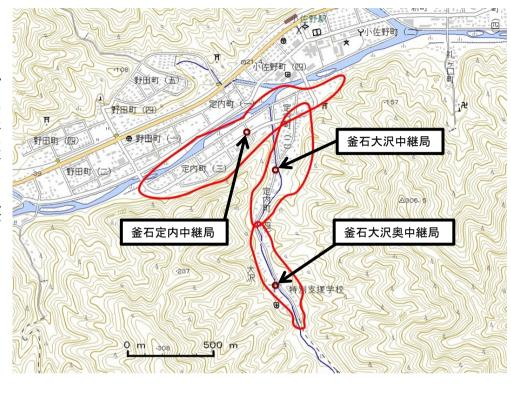
釜石大沢地区中継局は釜石局と同じチャンネルですが、偏波面は垂直偏波で送信されています。地上デジタルテレビ放送用の電波を受信するためには、下図のようにUHF専用のアンテナを垂直偏波に設定して設置する必要があります。
