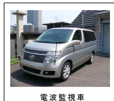
当局には、計4台の電波監視車が配備されており、車内には、様々な電波を受信するための無線受信機のほか、電波の到来方向を測定する方位測定装置等の機材を搭載しています。
