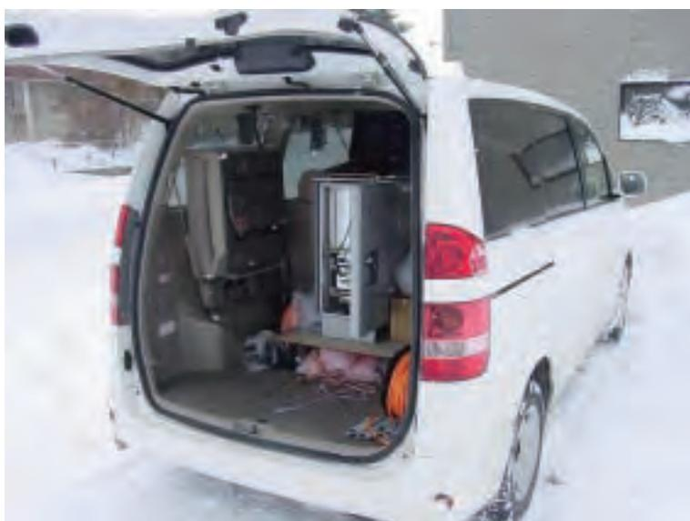
写真 4-2-9 DSRC 制御部設置状況（車両内に設置）
