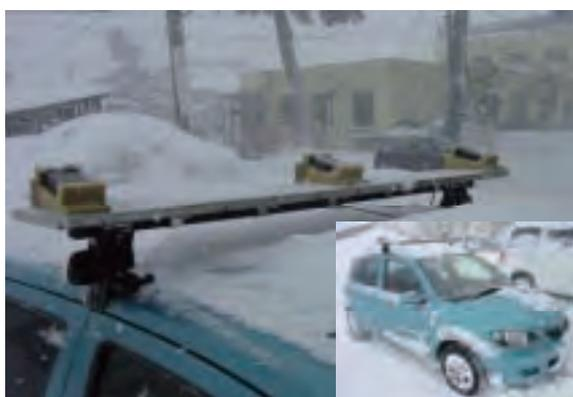
写真4-2-6 電界強度測定車両及びアンテナ
