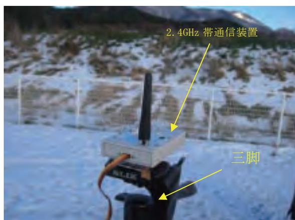
写真 4-2-4 2.4GHz 帯通信装置の外観
