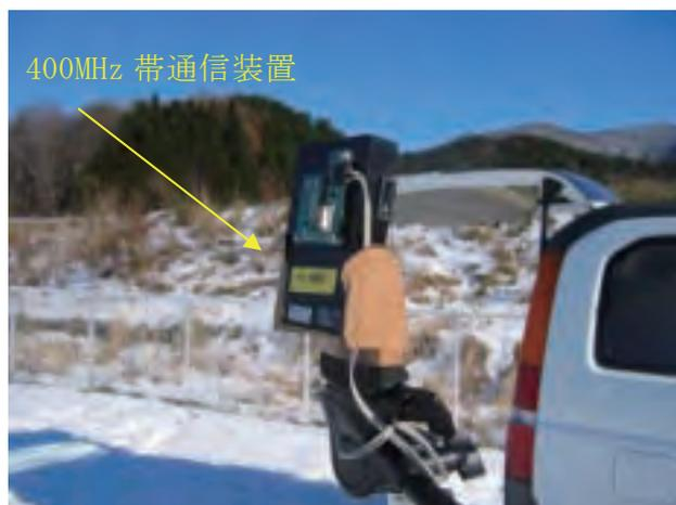
写真 4-2-5 400MHz 帯通信装置の外観
