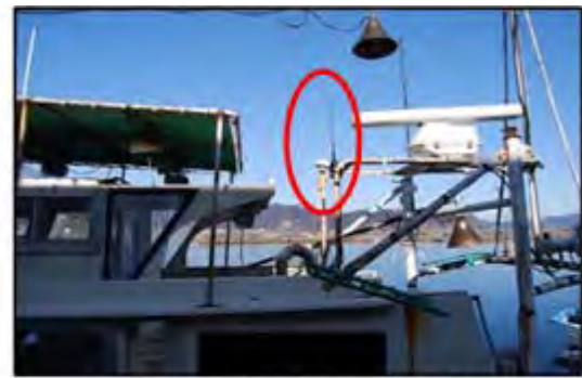
小電力セキュリティ受信アンテナ (海面高2.5m)
