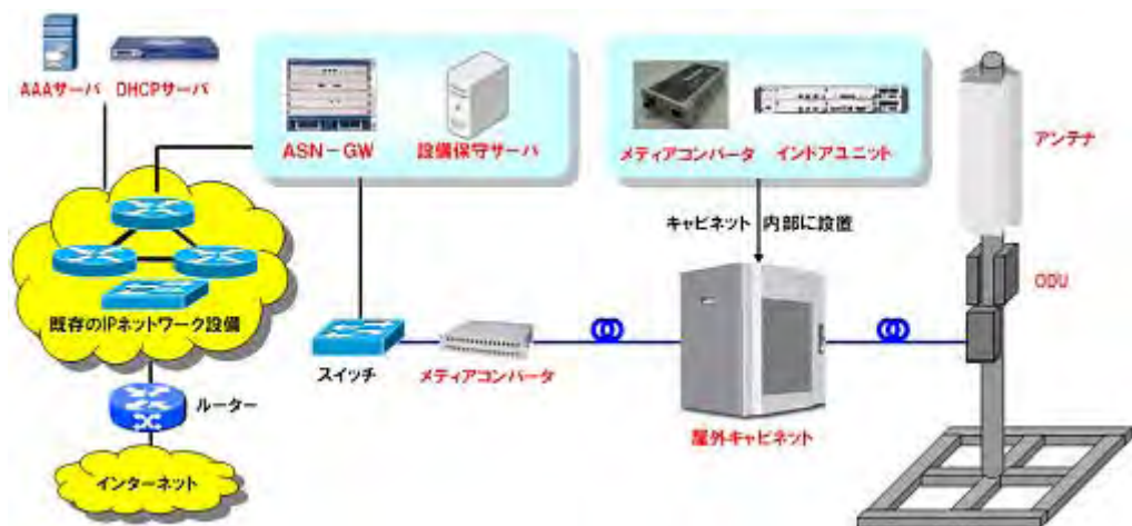
WiMAX システムの機器構成
